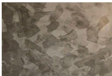
Grâce au chevauchement, la structure typique d'une application à la spatule est créée. Les couleurs apparaissent plus uniformément après le séchage.
